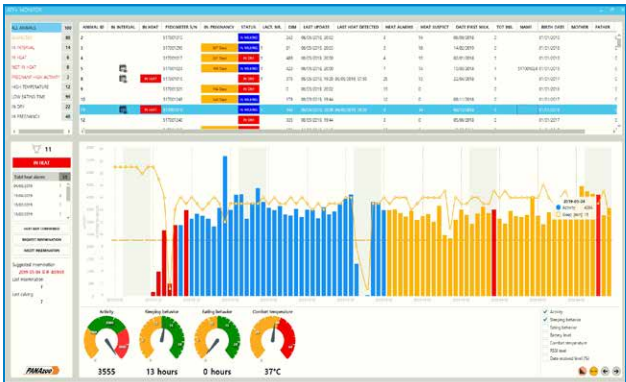
Система выявления коров в "охоте", педометр
